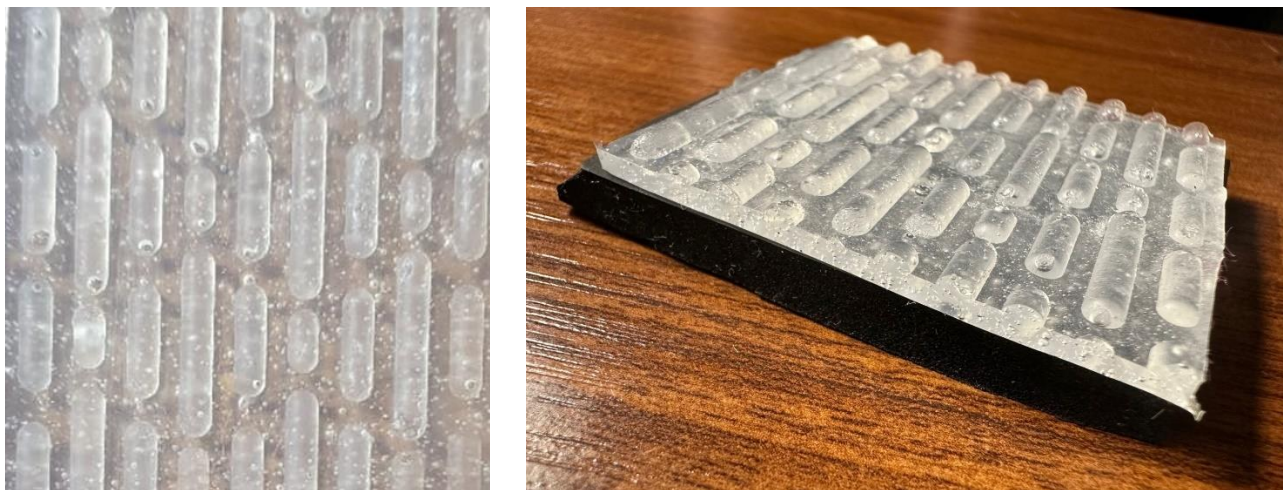
Рисунок 42 – Внешний вид изготовленного образца нового силиконового термостойкого барьерного покрытия с бионической структурой рельефа
