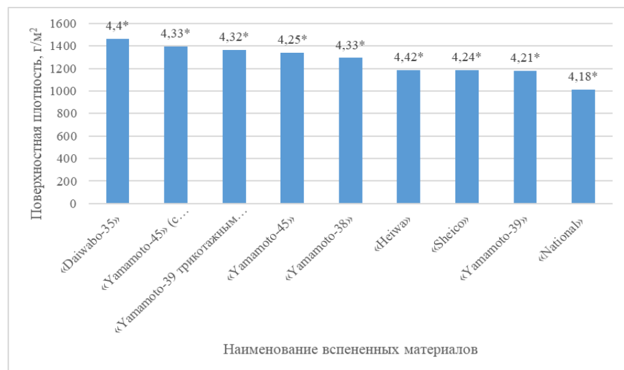
Рисунок 28 – Параметры поверхностной плотности образцов типовых вспененных материалов типа неопрен (для гидрокостюмов): * – толщина материала, мм
