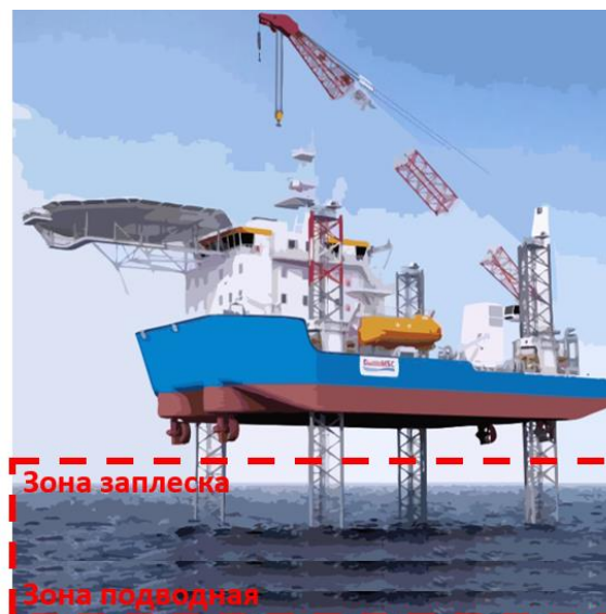
Рисунок 1 – Типовые водные зоны (заплесковая и подводная) при морском сооружении с наиболее вероятными участками работы подводных сварщиков
