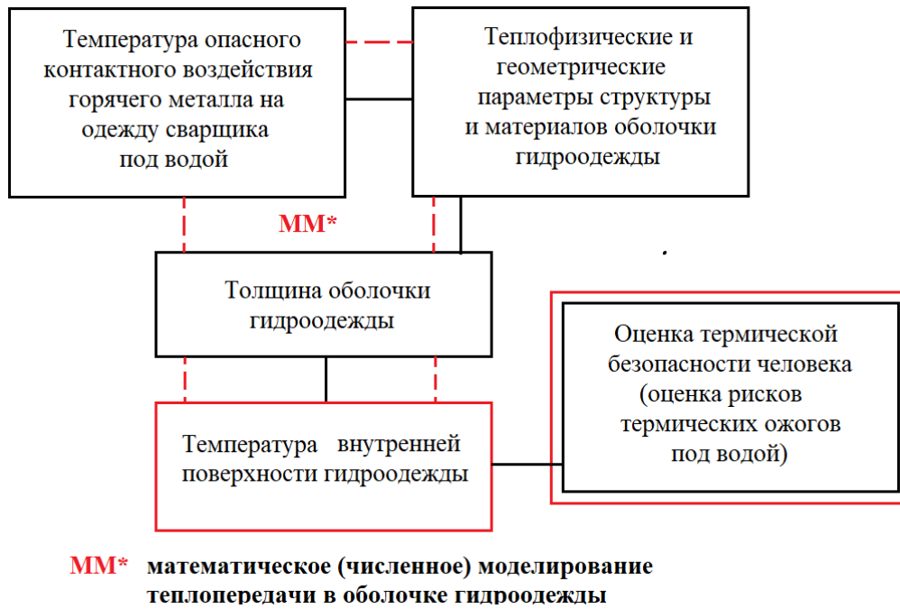
Рисунок 52 – Концепция автоматизированного способа оценки и прогнозирования термической безопасности человека в гидроодежде при подводной сварке
