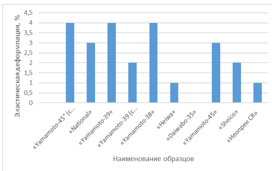
Рисунок 31 – График показателей эластической деформации образцов неопрена
